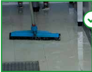
Fig. 3 | Convogliare l'acqua verso gli scarichi con una spatola tira acqua avendo cura di non sollevare schizzi
