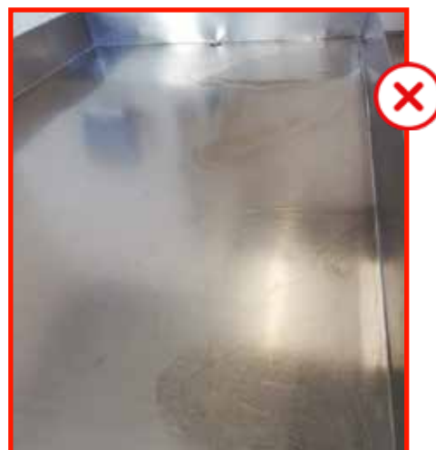
Fig. 21 | Superficie non adeguatamente pulita: presenza di aloni opachi
