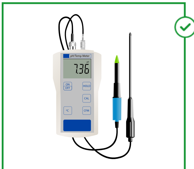
Fig. 50 | Ph-metro per misurazione grado di acidità degli innesti
