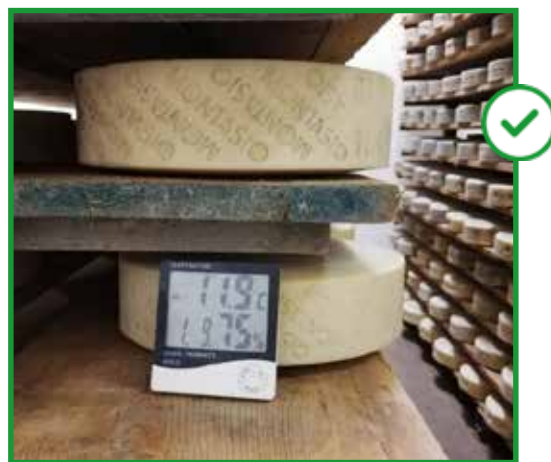
Fig. 52 | Controllo temperatura e umidità in locale di stagionatura
