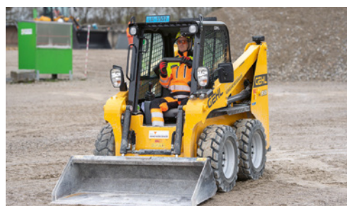
5 Piccolo escavatore con cintura di sicurezza e protezione in caso di ribaltamento (ROPS/TOPS).
