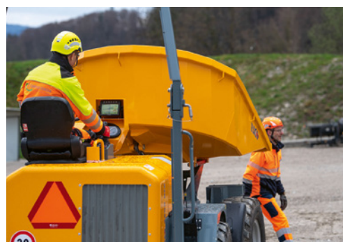
9 Persona nella zona di pericolo: con una misura tecnica (videocamera) è possibile vederla in tempo.
