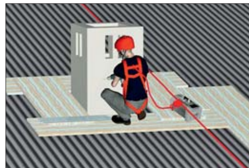
Fig. 4: sui tetti non resistenti alla rottura o con resistenza limitata alla rottura si lavora con la fune di sicurezza e su una superficie sicura.
