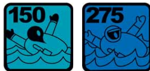
Fig. 6: i giubbotti di salvataggio devono avere una spinta idrostatica minima di 150 N (EN ISO 12402-3/-2).
