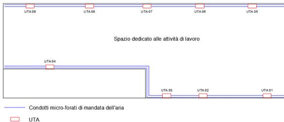
**Schema planimetrico dello stabilimento - impianto estrazione polveri e immissione aria**
