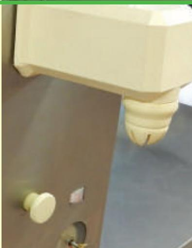
*Diverse parti interne possono essere fonte di inquinamento batterico di tipo secondario. A seconda del tipo di macchinario sono da tenere in particolare considerazione giunti, raccordi e guarnizioni*
