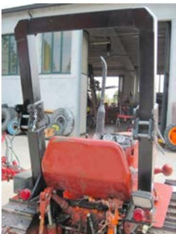
Tutti i trattori agricoli a ruote e a cingoli devono avere una struttura di protezione (cabina o telaio) del posto di guida in caso di ribaltamento.
