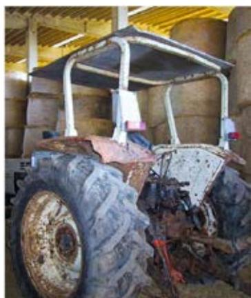
I componenti del telaio/arco di protezione del posto di guida (tubolari, piastre, flange, giunti saldati, viti e bulloni), nel tempo si possono usurare.
