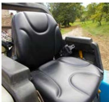
I trattori devono avere un dispositivo di ritenzione (cintura di sicurezza) che, in caso di capovolgimento del mezzo, trattiene il conducente al sedile, cioè all'interno di un volume di sicurezza.
