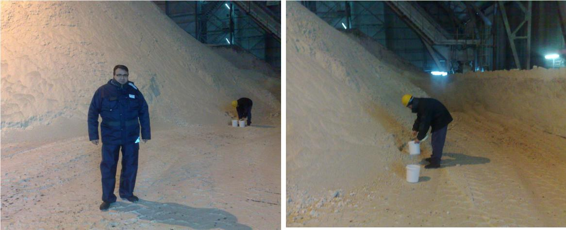
**Figura 1.3** – *Campionamento di carbone dal parco di stoccaggio (sinistra) e ITAR (destra)*
