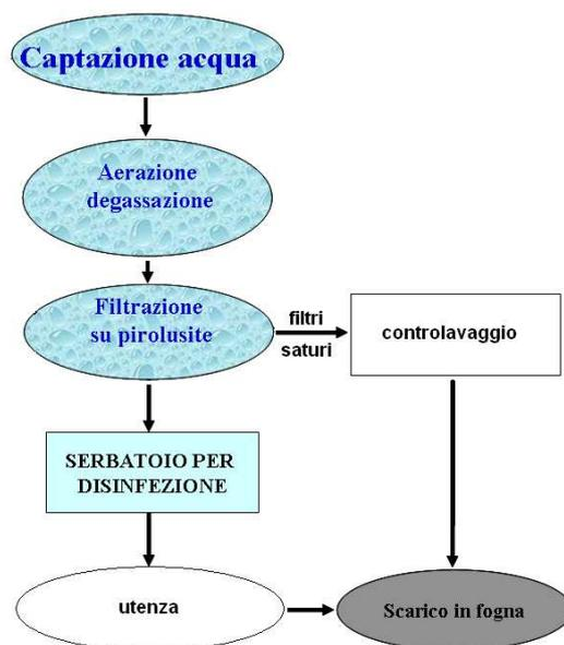
Figura 2.1 – Schema impianto di trattamento a pirolusite a Castelletto Cervo
