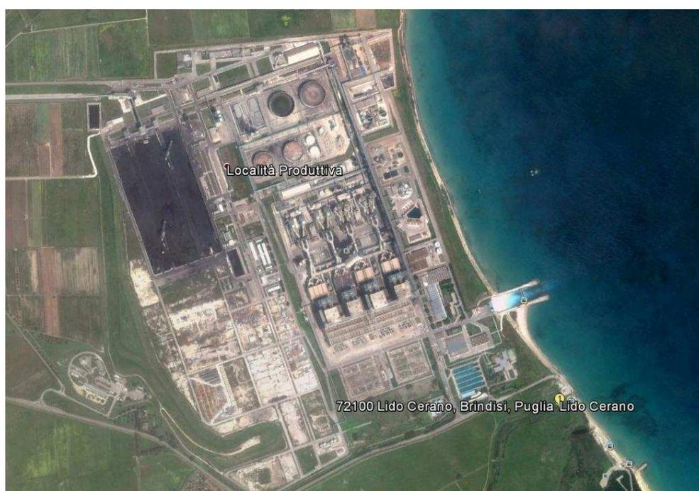
L'impianto è costituito da quattro sezioni identiche alimentate a carbone (come combustibile primario), olio combustibile e gasolio per una potenza nominale complessiva di 2640 MWe (MegaWatt elettrici). Al 2005, la capacità produttiva complessiva dichiarata risulta essere di 6.560 MWt (MegaWatt termici) - circa 1700 MWt per gruppo), corrispondente a una produzione effettiva di 16.361.405 MWh (MegaWatt ora).
