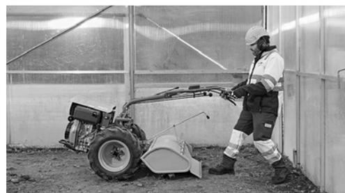
4 Macchina con dispositivo antintrappolamento
