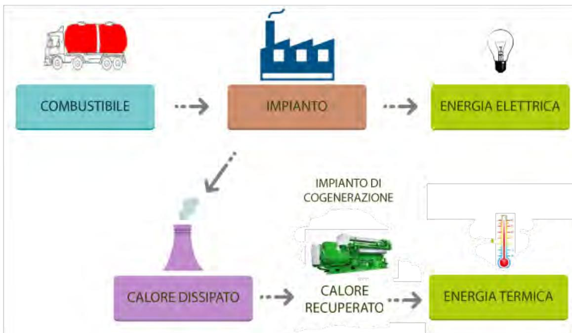
Figura 1. Schema funzionamento processo cogenerativo
