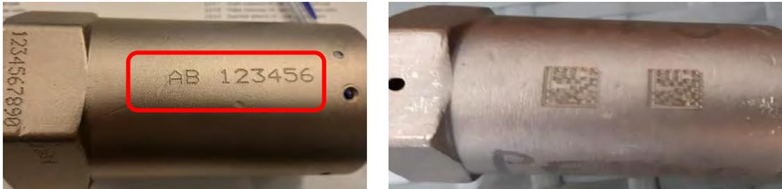
Figura 11. Prove di marcatura micropercussione su VS per GPL, riconoscibili con strumento di lettura apposito
