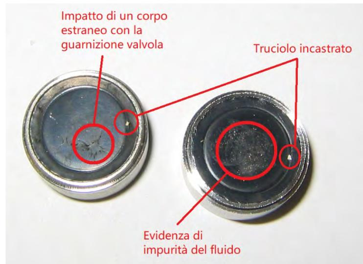
Figura 12. Particolare sede con danneggiamento della tenuta
