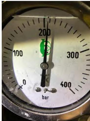
Figura 11. Manometro alla pressione di prova idraulica
