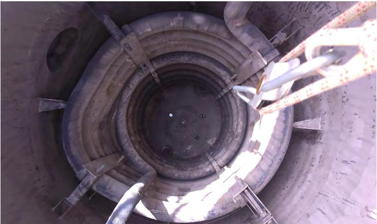
Figura 2. Aspetto interno del reattore di idrogenazione con la camicia interna
