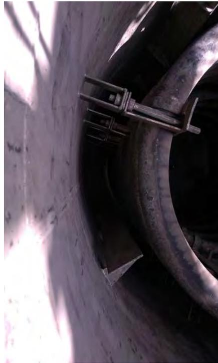
Figura 1. Particolare del reattore di idrogenazione con la camicia interna
