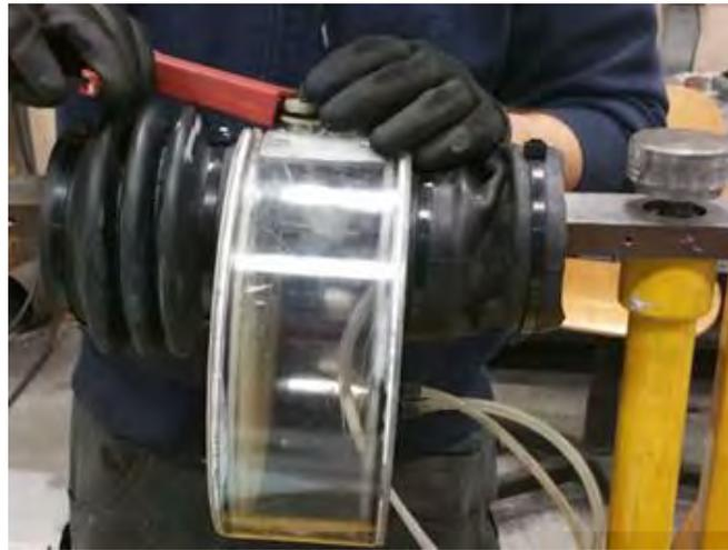
Figura 1. Recipienti per il contenimento della soluzione di prova
