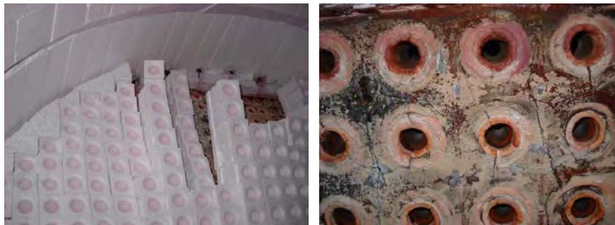
Figura 6. Rotture e distacco ferule ceramiche, con ossidazione piastra tubiera e tubi sottostanti.
