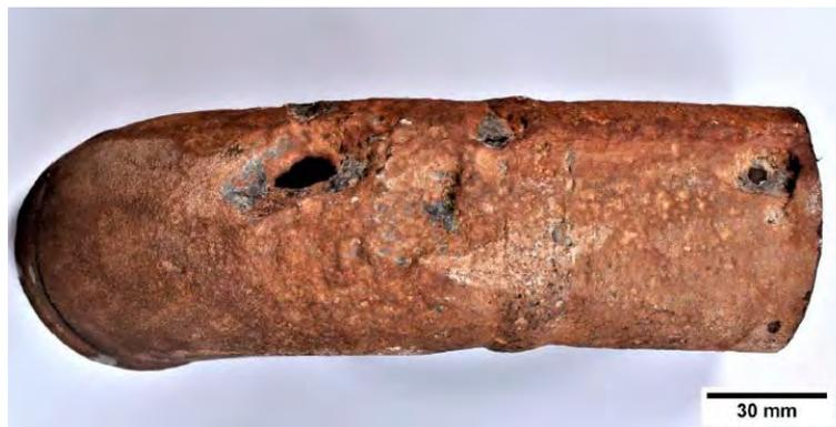
Figura 6. Tubazione interrata in acciaio al C interessata da corrosione microbiologica da batteri solfato riduttori [21]
