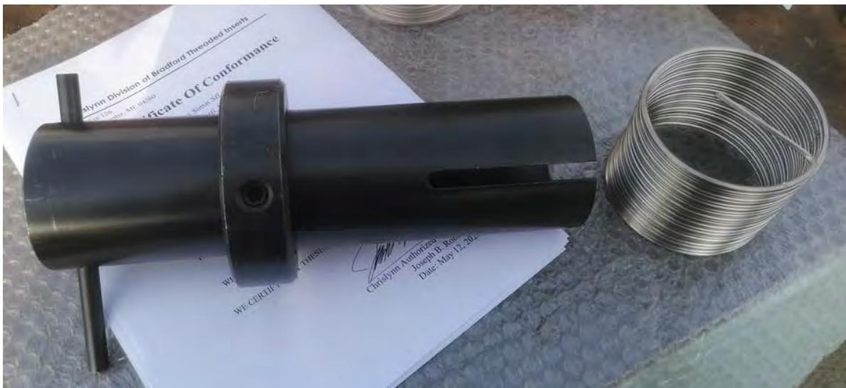
Figura 9. Una immagine dell'elicoide e dello strumento manuale per la sua installazione all'interno della madrevite del distributore
