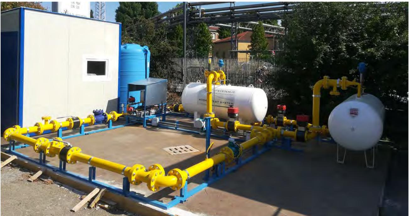
Figura 2. Circuito di prova per la pressurizzazione di due serbatoi.
