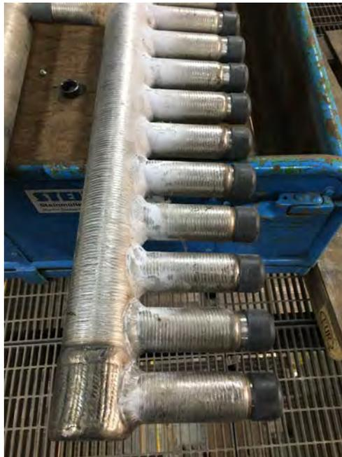
Figura 1. Collettore inferiore rivestito in Inconel 625
