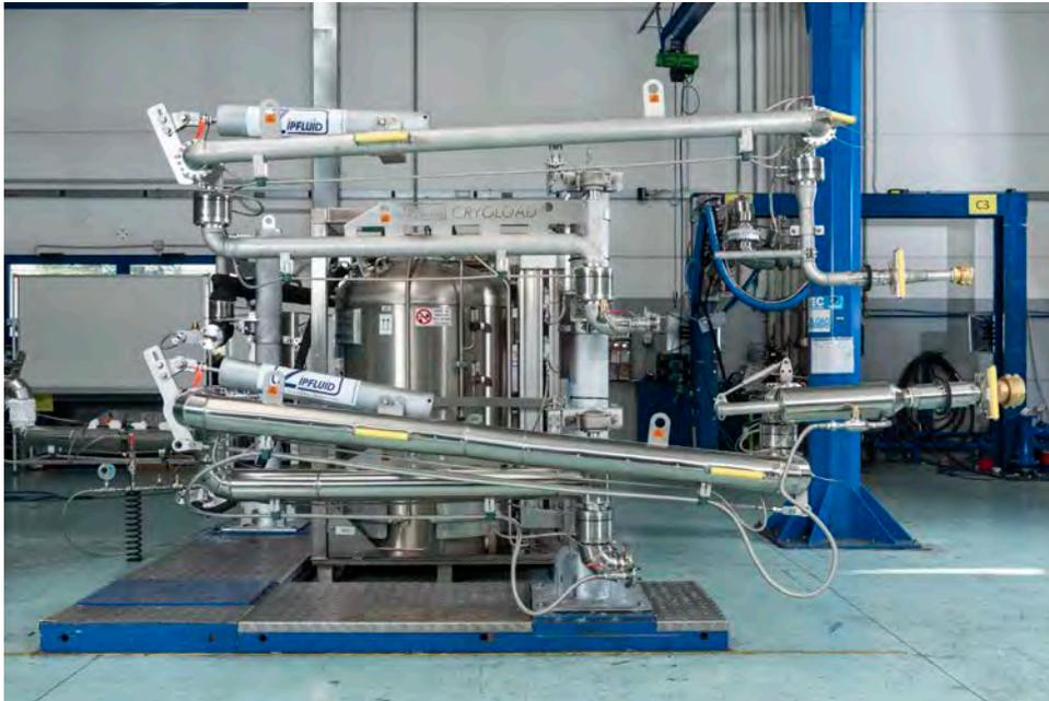
Figura 5. Bracci di carico autobotti (su gentile concessione di Zipfluid srl)
