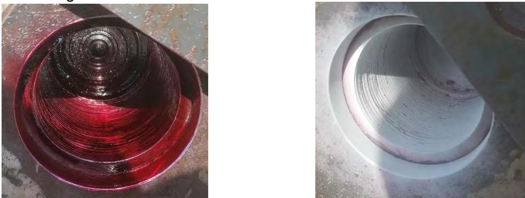
Figura 7. Esecuzione di controllo con liquidi penetranti a valle della fase di alesaggio
