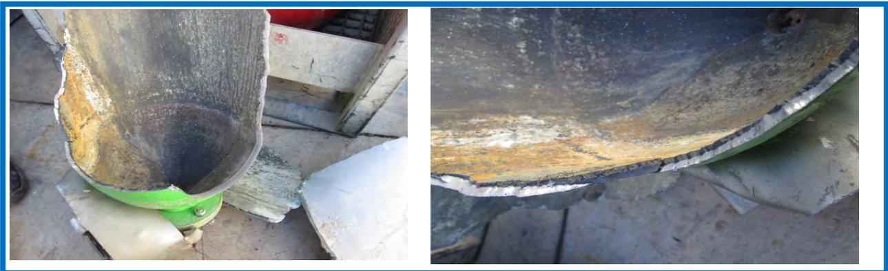
Figura 2. Bombola rinvenuta non correttamente in modo generalizzato senza particolari corrosioni
