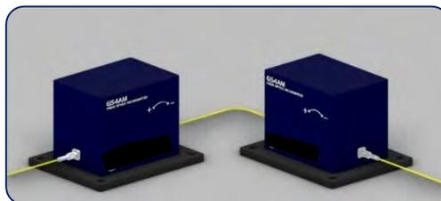
Figura 6. Inclinometri monoassiali GS4AM posizionati a 90° l'uno rispetto all'altro per poter campionare indipendentemente l'inclinazione attorno all'asse X e attorno all'asse Y.
