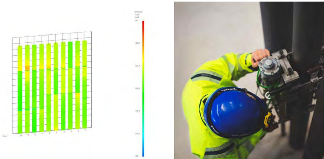
Figura 9. Risultati controlli con correnti indotte Figura 10. Esecuzione correnti indotte
