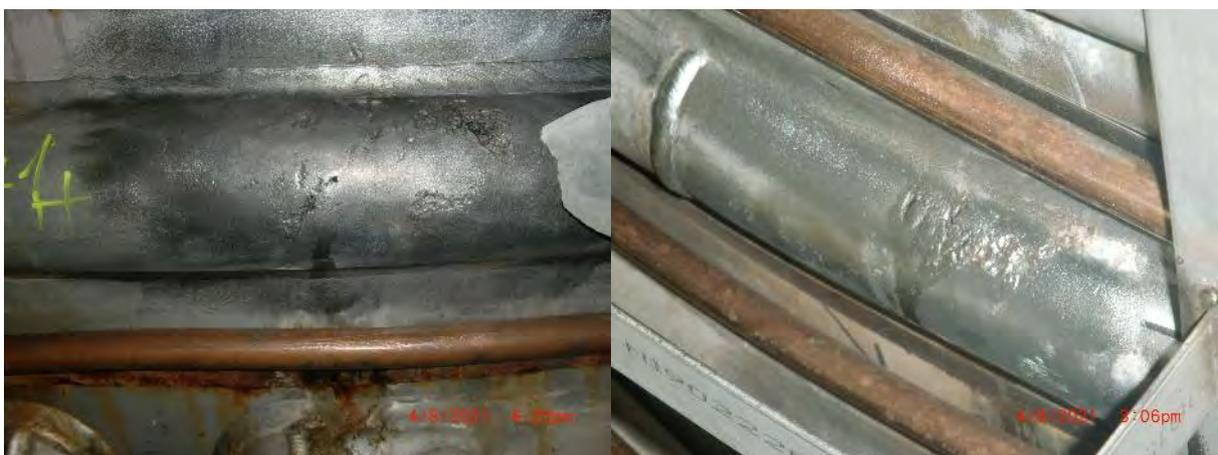
Figura 3. Dettaglio corrosioni dopo preparazione superficiale; in evidenza le tracciate di vapore in corrispondenza della zona di intervento
