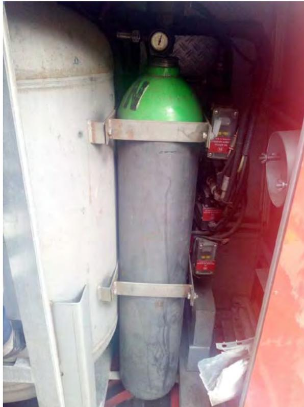
Figura 7. Particolare bombola aria compressa con serbatoio afferente
