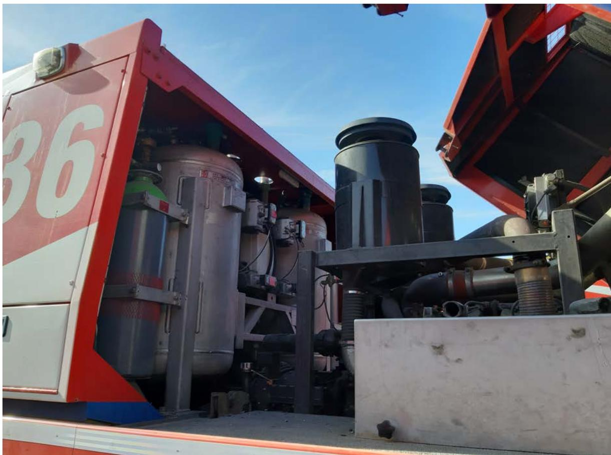
Figura 4. Serbatoio estinguente e bombola di alimentazione – Serbatoi A e B
