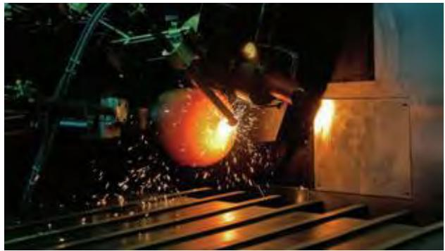
Figura 3. [2] Macchina per ogivatura (Hot Spinning)
