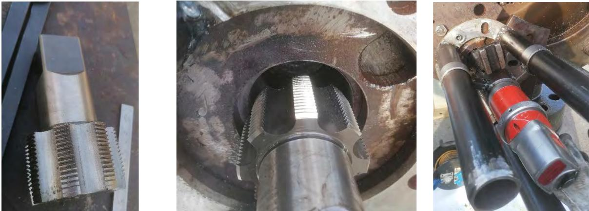
Figura 8. Maschio, posizionamento della testa nei pressi del foro, posizionamento generale
