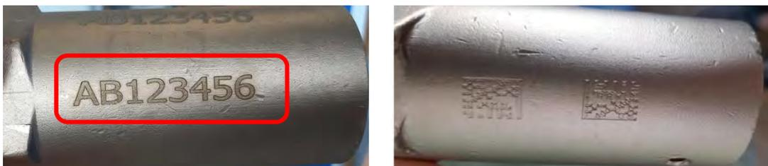
Figura 12. Prove di marcatura a laser su VS per GPL, riconoscibili con strumento di lettura apposito
