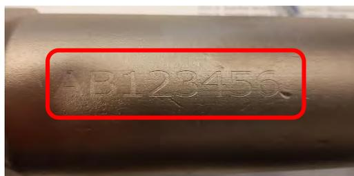
Figura 13. Valvola di fig 12 (Sx) dopo essere stata sabbiata 1 sola volta
