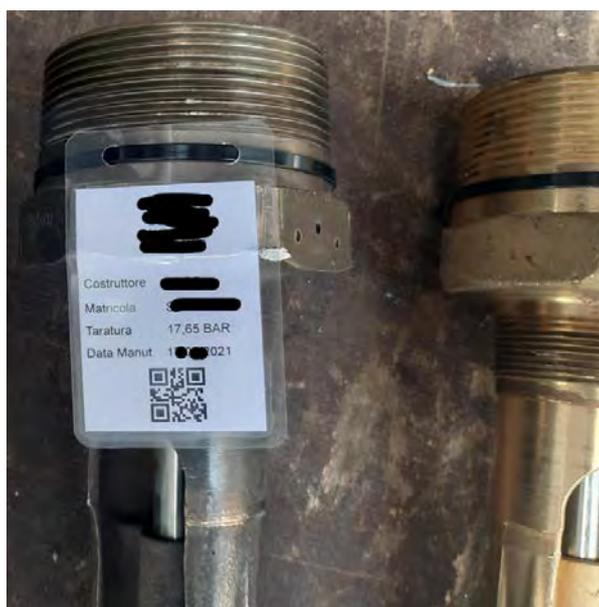
Figura 1. Marcatura con QR Code di VS x GPL, leggibile con qualunque smartphone riporta al verbale di taratura
