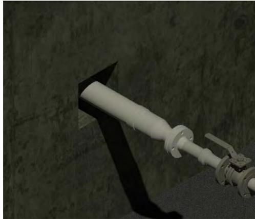
Figura 3. tubazione di prelievo del GPL di un serbatoio tumulato
