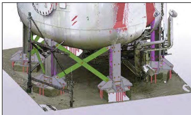
Figura 9. Sovrapposizione tra modello del costruttivo in carpenteria e rilievo laser scanner di un serbatoio verticale
