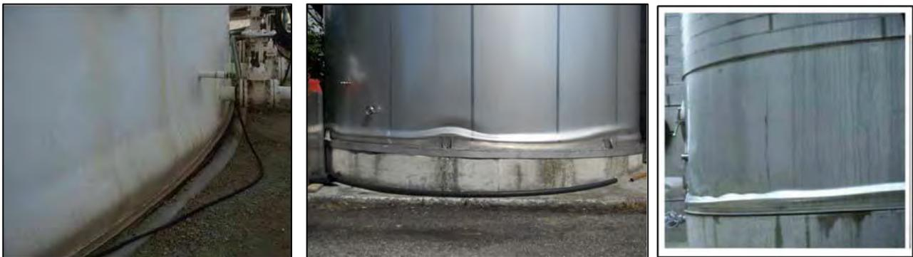
Figura 5. Instabilità elastoplastica "elephant foot buckling"
