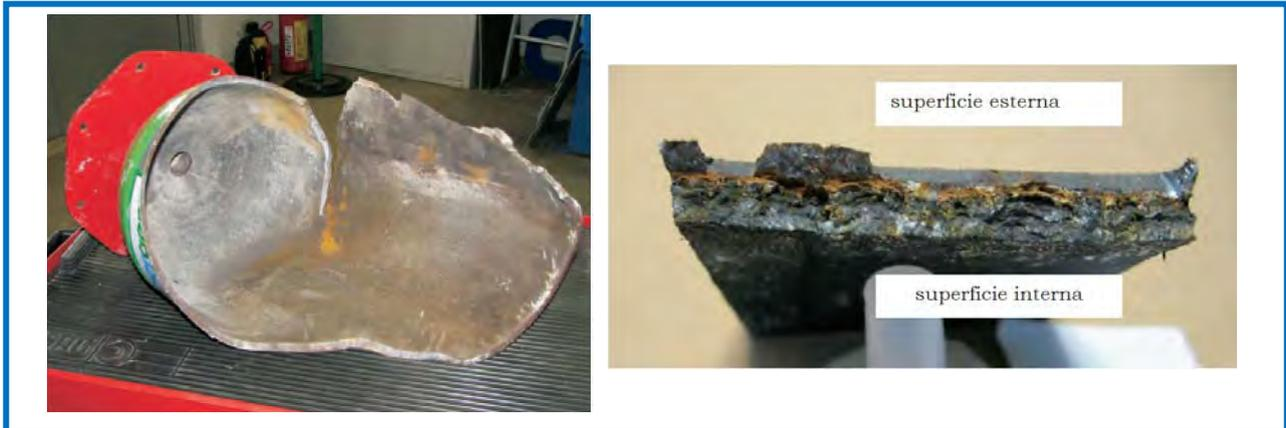
Figura 3. Bombola rinvenuta correttamente ma con tensocorrosione non facilmente visibile dall'interno: si presume il contenimento di acqua insieme ad agenti estinguenti
