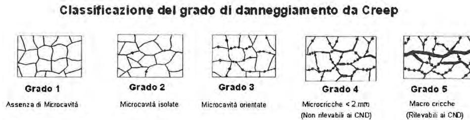
Figura 6. Classificazione del grado di danneggiamento da Creep
