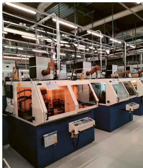
1 Officina di décolletage provvista di ventilazione artificiale. Una volta filtrata, l'aria viene reimessa nella zona di lavoro.
