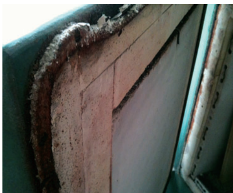
Corda in crisotilo a protezione del portello di un forno per ceramica
