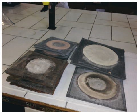
Retine spargifiamma di diversa natura risalenti a periodi differenti. Alcune di queste contengono amianto crisotilo.
