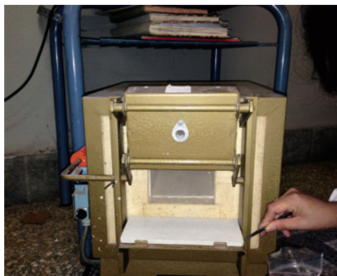
Pannello protettivo di un fornello da laboratorio in amianto crisotilo
